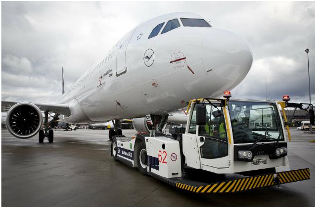
2. ábra: Orrfutókereket megemelő „PHOENIX E” Goldhofer vontató
